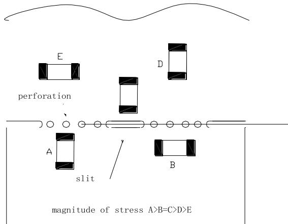
在沿着分拨线分拨电路板时，对产品施加的机械应力与使用的方法关系很大。分折电路板时片状元件受到的疲劳按照如下顺序增大：分折、剪切、V型槽、穿孔。因此，贴装时应该考虑电路板的分拨过程。
