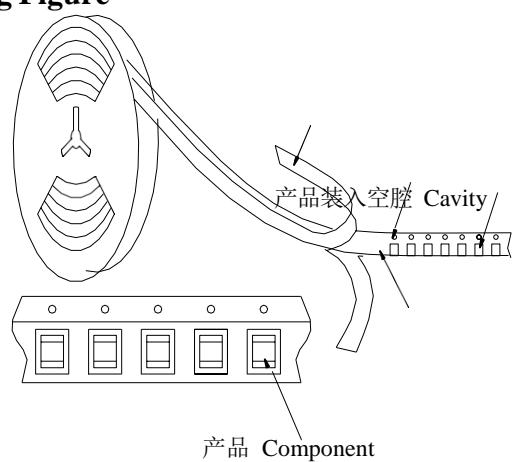
空白部分 Empty section 产品装入部分 Chip insertion section 空白部分 Empty section
